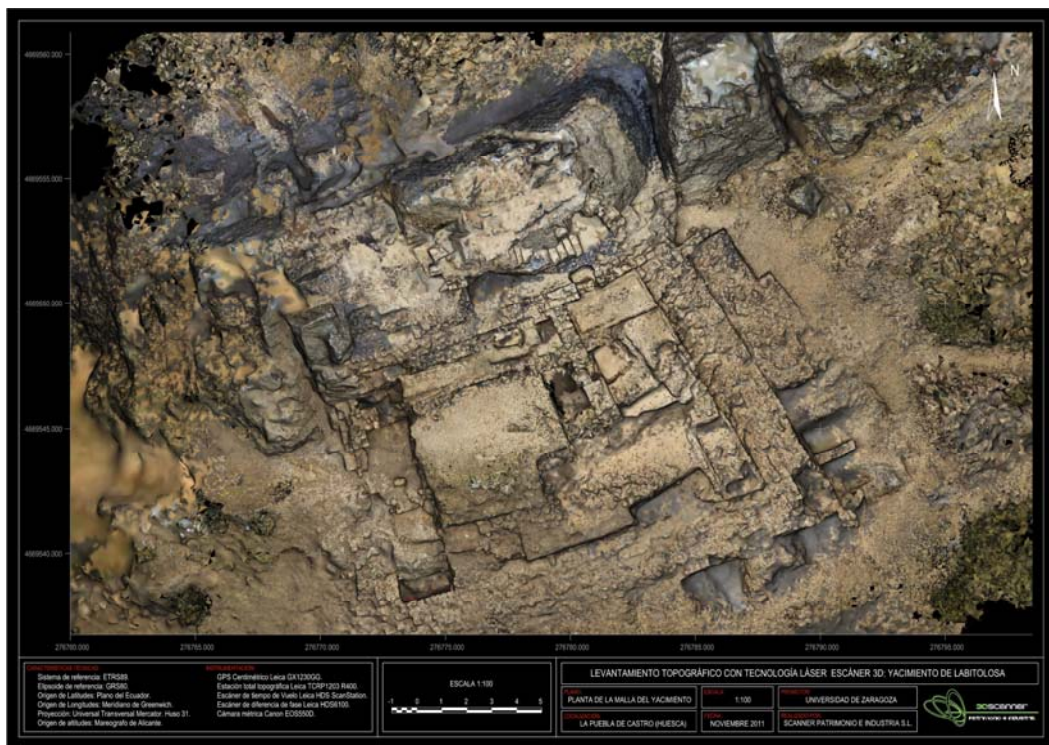
Fig. 9. Levantamiento topográfico con tecnología láser escáner 3D del Hinc de Cerro Calvario.
